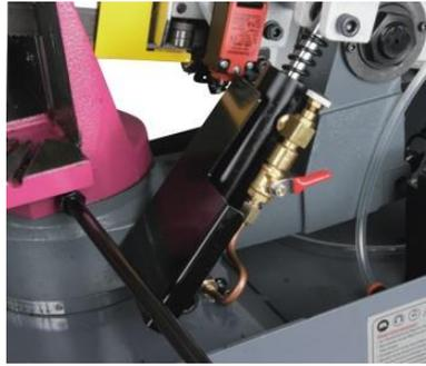
Регулирование скорости подачи гидроцилиндром противодействия.
