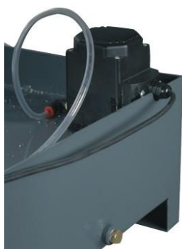
Высокопроизводительный насос подачи СОЖ. Бак 25 л.
