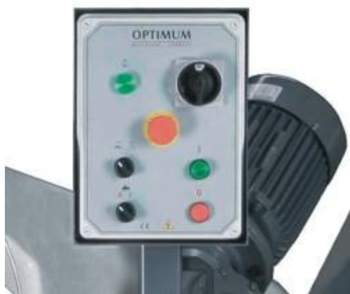
Удобная поворотная панель управления.
