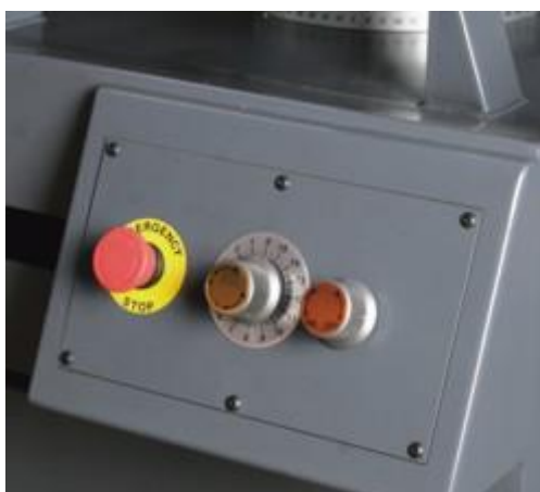
Простая регулировка скорости опускания пильной рамы. Кнопка аварийной остановки.
