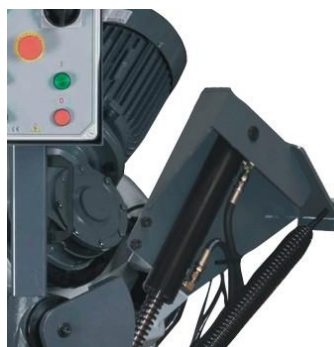
Две скорости резания, переключаемые на панели управления.
