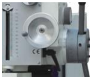
Подача пиноли Маховик микрометрической и рукоятка грубой подачи пиноли, механизм автоматической подачи
