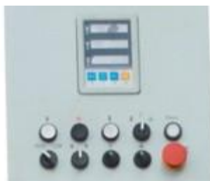
Панель управления Фирменная панель управления Optimum со встроенным УЦИ
