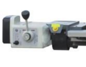
Подача стола Привод автоматической подачи стола по оси X
