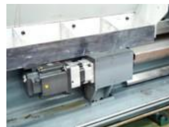
Привод оси Z Точный планетарный редуктор прямого подключения
