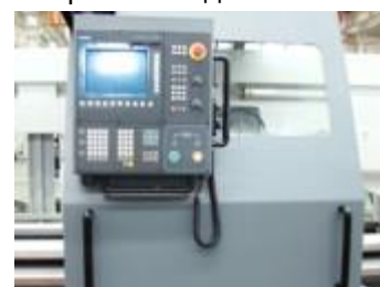
Система ЧПУ Siemens 828D Современная высокопроизводительная система управления
