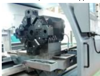
8-позиционный сменщик инструмента (опция) Значительно расширяет возможности обработки
