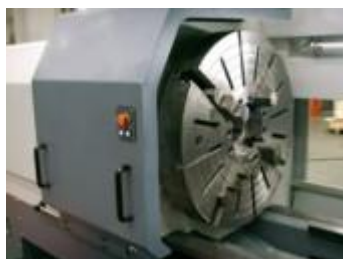
Токарный патрон 4-кулачковый механический патрон, до 315 об/мин, заготовки до 1500 кг
