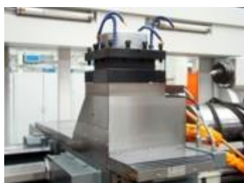
4-позиционный сменщик инструмента Максимальная жесткость и максимальный диаметр обработки
