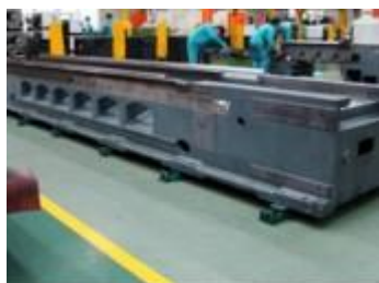
Станина Цельнолитая станина высокой жесткости
