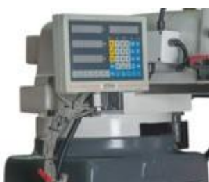
Цифровая индикация Трехосевое устройство цифровой индикации позиций и перемещений.
